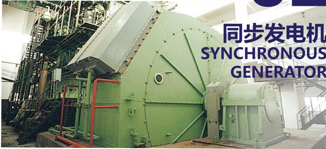
同步发电机，即转子转速与定子旋转磁场的转速相同的交流发电机。按结构可分为旋转电枢和旋转磁场两种。同步发电机一般采用直流励磁，通过调节励磁电流，能方便地调节发电机的电压、功率因数和无功功率。在现代电力工业中，它广泛应用于水力发电、火力发电、核能发电以及柴油机发电，是一种最常用的交流发电机。
